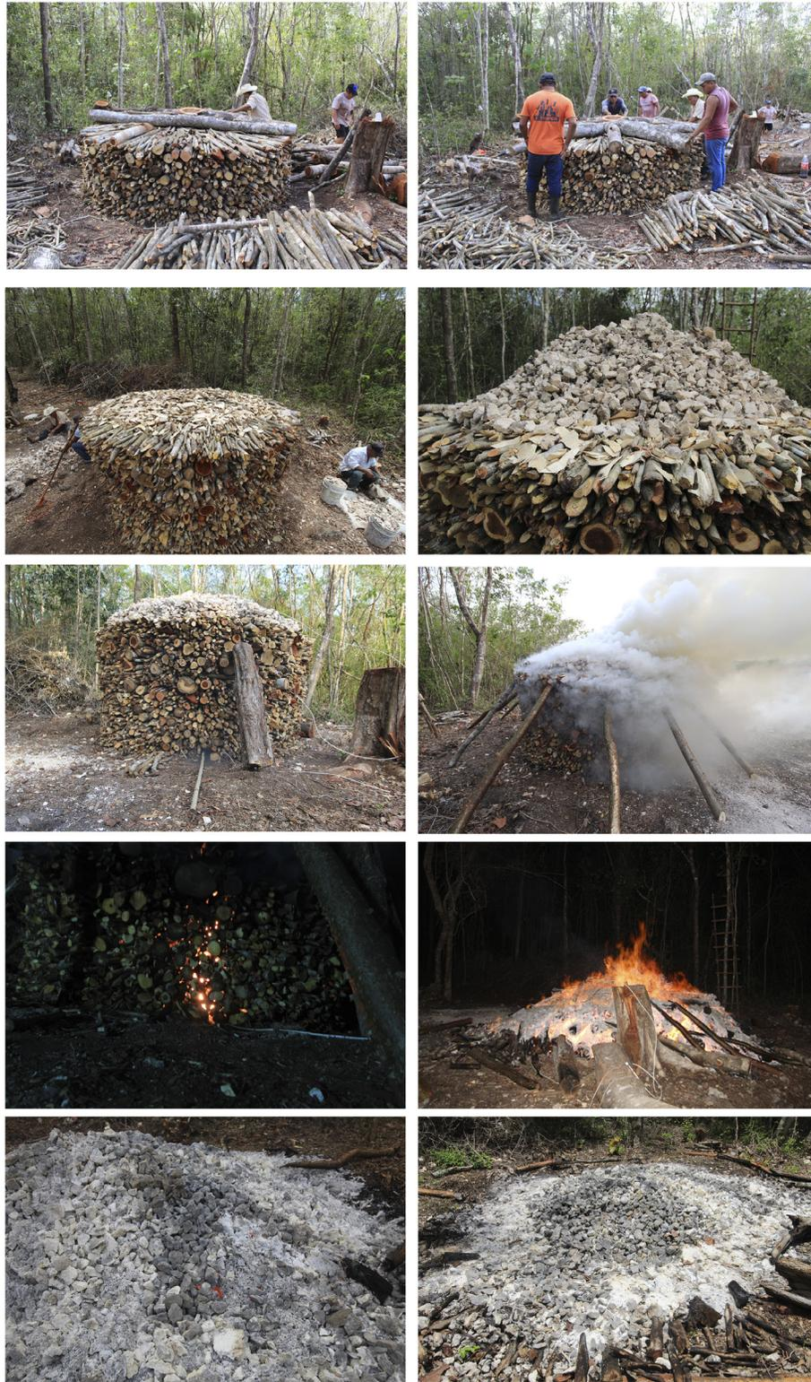
Figura 4 Proceso de construcción y quema de la calera artesanal en Uayma, Yucatán.
