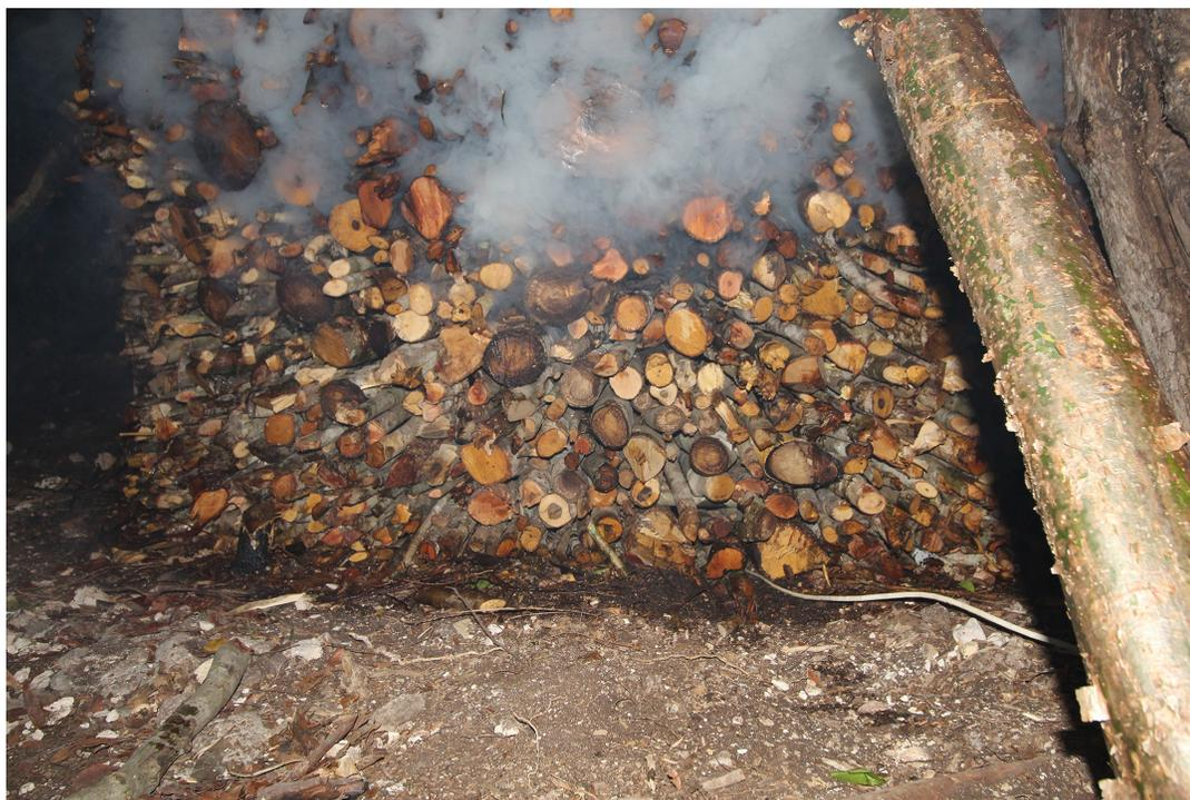
**Figura 2** Calera en proceso de calentamiento y calcinación, en el suelo se registra la presencia de la savia, agua y las resinas que contenía el combustible cayendo, y se observa la diferencia entre la zona más húmeda y la más seca conforme se va calentando la calera.
