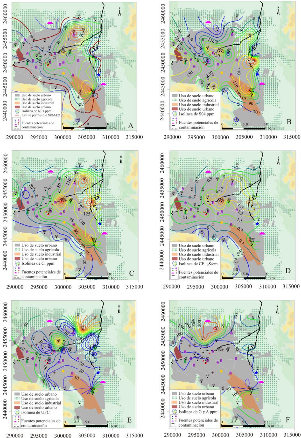
Figura 5. Distribución espacial de A: NO<sub>3</sub><sup>-1</sup>, B: SO<sub>4</sub><sup>-2</sup>, C: Cl<sup>-</sup>, D: CE, E: CT y F: G y A, basados en Moran-Ramírez, 2010.
