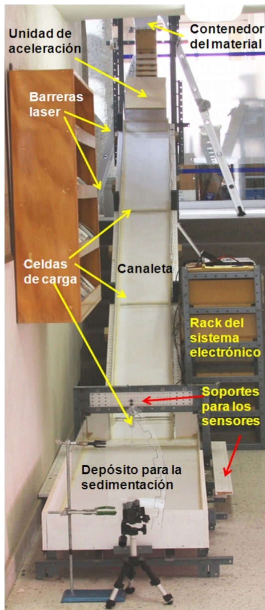
Figura 1. Diferentes partes que conforman el aparato GRANFLOW-SIM, se puede apreciar la modularidad del aparato.
