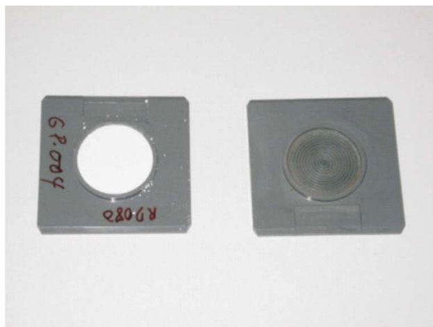
Figura 1. Portamuestras para polvo en difracción de rayos X, con y sin polvo cristalino.
