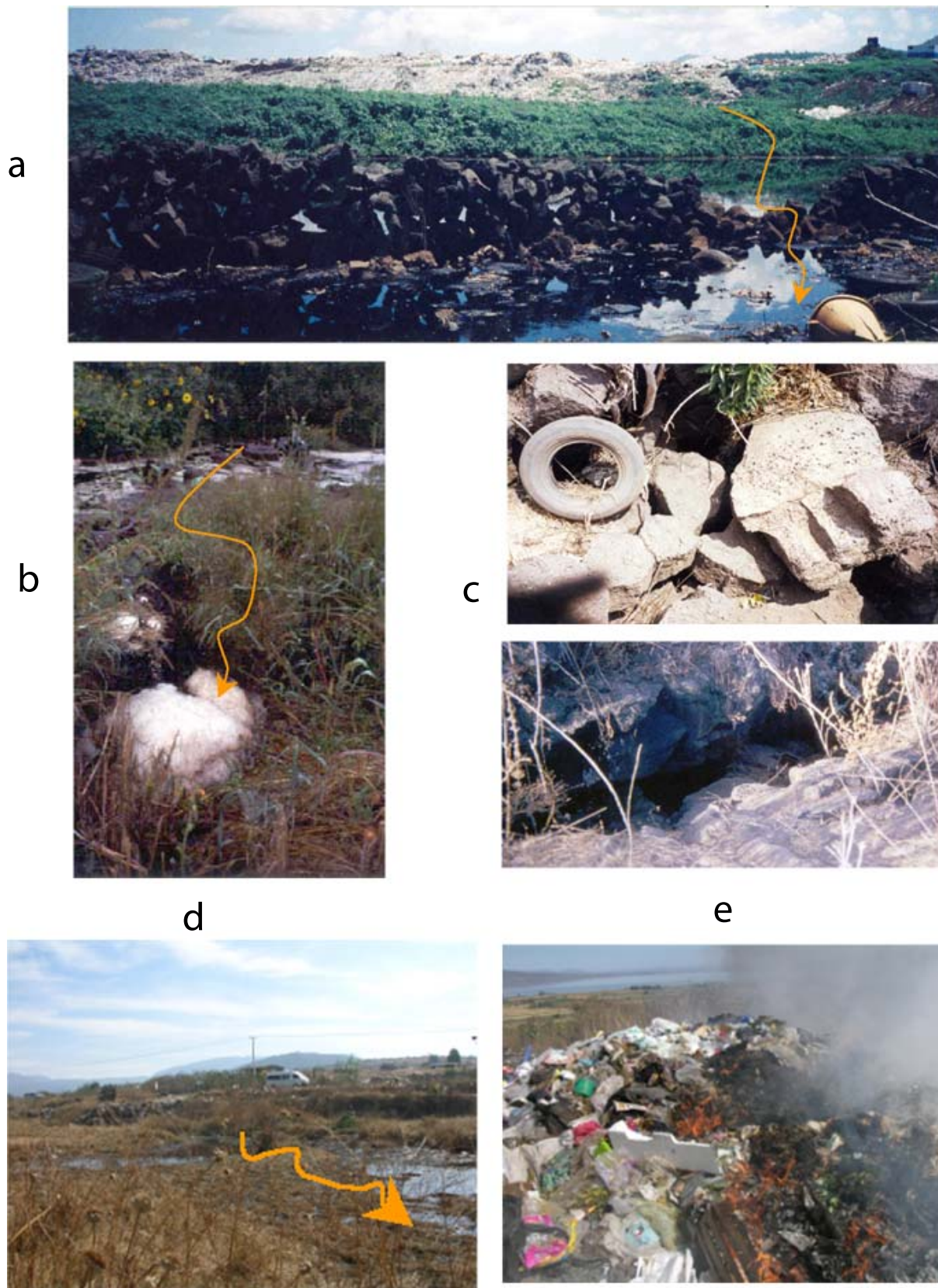
Figura 3. Índice de imágenes tomadas el 22 de diciembre del 2007, excluyendo la del tiradero de Morelia que fueron tomadas en agosto del 2004. a) Charcas de lixiviados que escurren hacia fracturas. b) Detalle de los escurrimientos hacia fracturas en periodo de lluvias y de estiaje. c) Residuos clínicos de la región de Morelia. d) Escurrimiento de lixiviados del tiradero de Zinapécuaro. e) Combustión constante de Copándaro. f) Tiradero en la orilla de la carretera de Téjaro. g) Tiradero de Charo que deposita en barrancos conformados por secuencias fluvio lacustres. h) Tiradero de Santa Ana Maya que invade al lago de Cuitzeo entre tulares. i) Tiradero de Uriangato. j) Tiradero en depósitos fluviolacustres de Indaparapeo. k) Tiradero de Álvaro Obregón. l) Tiradero de Tarímbaro atraviesa ductos de combustible. m) Tiradero de Huandacareo mostrando residuos porcinos.
