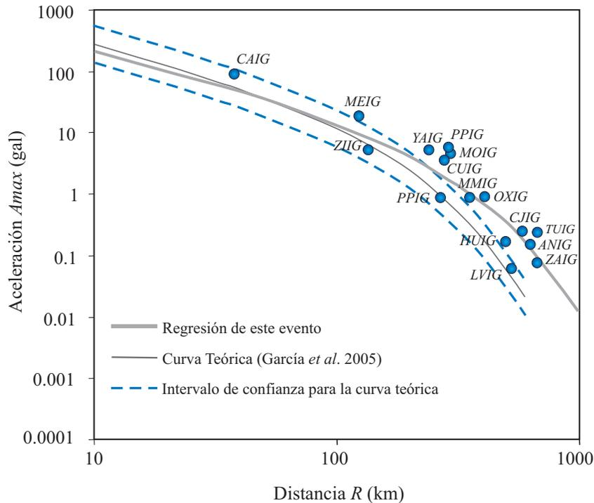
Figura 4. Aceleración pico horizontal  $A_{max}$  contra distancia hipocentral. Con línea continua gruesa se muestra la curva obtenida a partir de la regresión de los datos obtenidos para este sismo. Con línea continua delgada se muestra la curva teórica propuesta por García *et al.* (2005), y sus rangos de confiabilidad se muestran con líneas punteadas.
