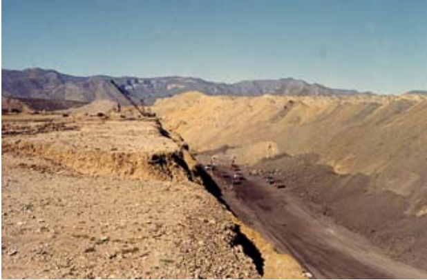
Figura 6. Vista panorámica del tajo La Florida ubicado en la subcuenca Saltillito-Lampacitos. Abajo en color negro se observa el manto principal de carbón de edad cretácica, el cual tiene en promedio 1.6 a 1.8 m de espesor (Fotografía del 11 de enero de 1972 tomada por el Ing. Luis Benavides).
