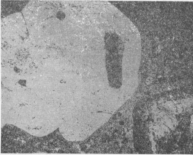
Foto 1. Fenocristales de cuarzo con bordes redondeados mostrando inclusiones de hornblenda. En la esquina inferior derecha hay un fenocristal de plagioclasa zoneado, mostrando acción hidrotermal. Nótense los cristales de apatita en la matriz y hasta en las inclusiones de hornblenda en el cuarzo. La matriz es ortoclasa; los puntos negros son de pirita. Luz ordinaria; 45 X. Niv. 800 de La Paz. Espécimen R-9.
