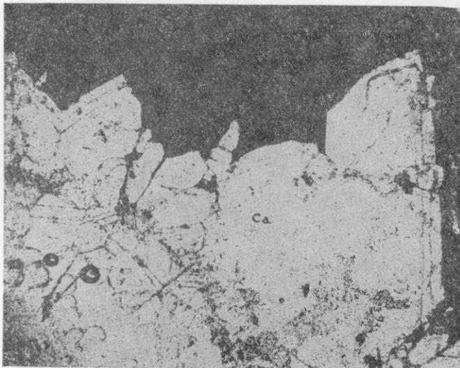
Foto 11. Pirita depositada coloidalmente sobre cristales euhedrales de calcita con espacios abiertos. Luz ordinaria; 40 X. Niv. 700 de La Paz. Espécimen R-4.
