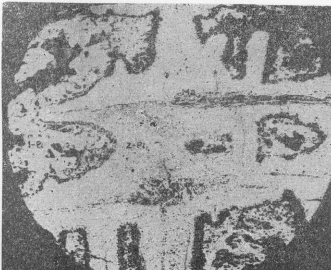
Foto 7. Dos distintas generaciones de pirita. La pirita depositada primeramente (1 P) es reemplazada por una pirita de grano más fino (2 P) a lo largo de fracturas. La marcasita está depositada después a lo largo de las mismas fracturas. Vetillas muy delgadas de calcita ocupan el centro de las de marcasita. Luz reflejada; 32 X. Nivel 440 de La Paz. Espécimen R-3.
